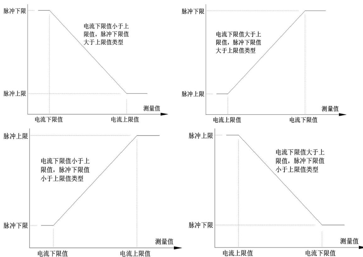
当前测量的电导率值对应斜线上的一个脉冲频率值，若当前测量值超出上下限，则输出的脉冲频率值就是用户自身设定的脉冲上下限值。
